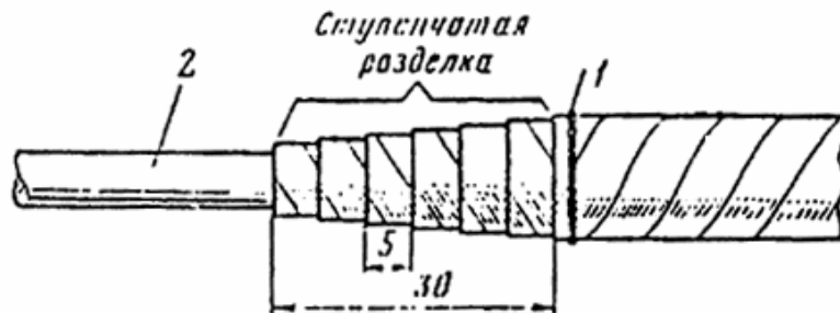
Рис. 54. Снятие изоляции с конца однопроволочной жилы.
