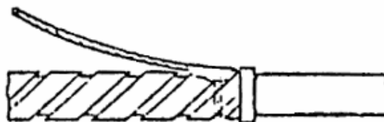
Рис. 56. Закрепление и припайка заземляющего проводника к броне кабеля с поливинилхлоридной или резиновой оболочкой.
