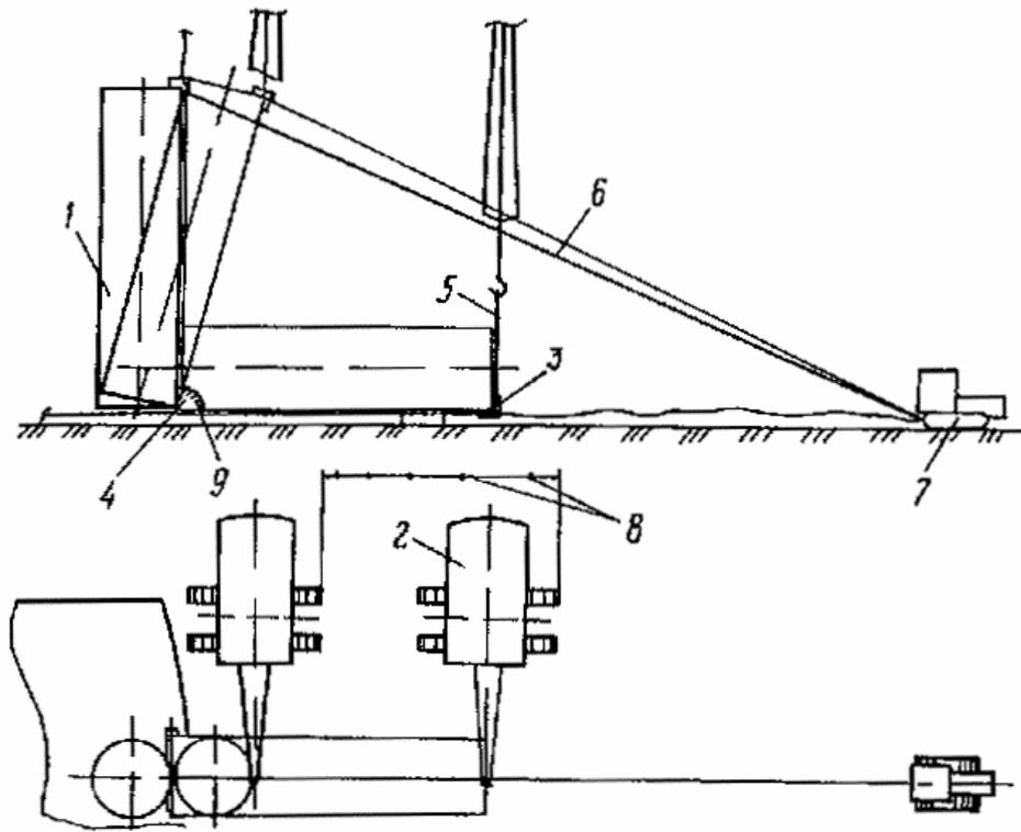
1 - рулон стенки; 2 - кран; 3 - захват для подъема рулона; 4 - шарнир; 5 - грузовой канат;
