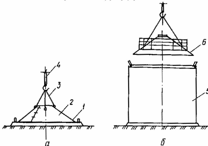
1 - днище резервуара; 2 - собираемые полотнища крыши; 3 - строп; 4 - кран; 5 - стенка резервуара; 6 - полностью собранная крыша
