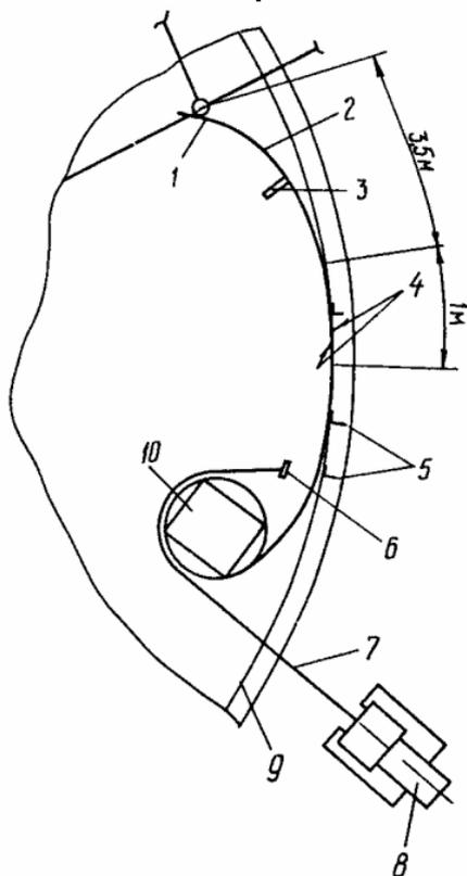
1 - труба жесткости; 2 - начальный участок полотнища стенки; 3 - упор; 4 - прихватка стенки к днищу; 5 - ограничительные уголки; 6 - скоба; 7 - удерживающий канат; 8 - трактор; 9 - риски для приварки ограничительных уголков; 10 - рулон стенки
