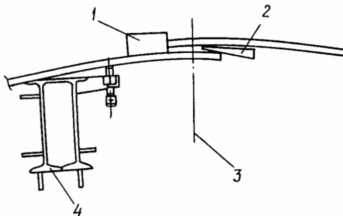
1 - ограничительная пластина; 2 - клин; 3 - ось вертикального монтажного стыка;
