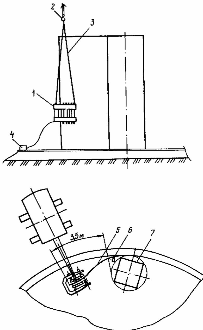
1 - гидравлическое устройство; 2 - кран; 3 - строп; 4 - пульт управления устройством;
