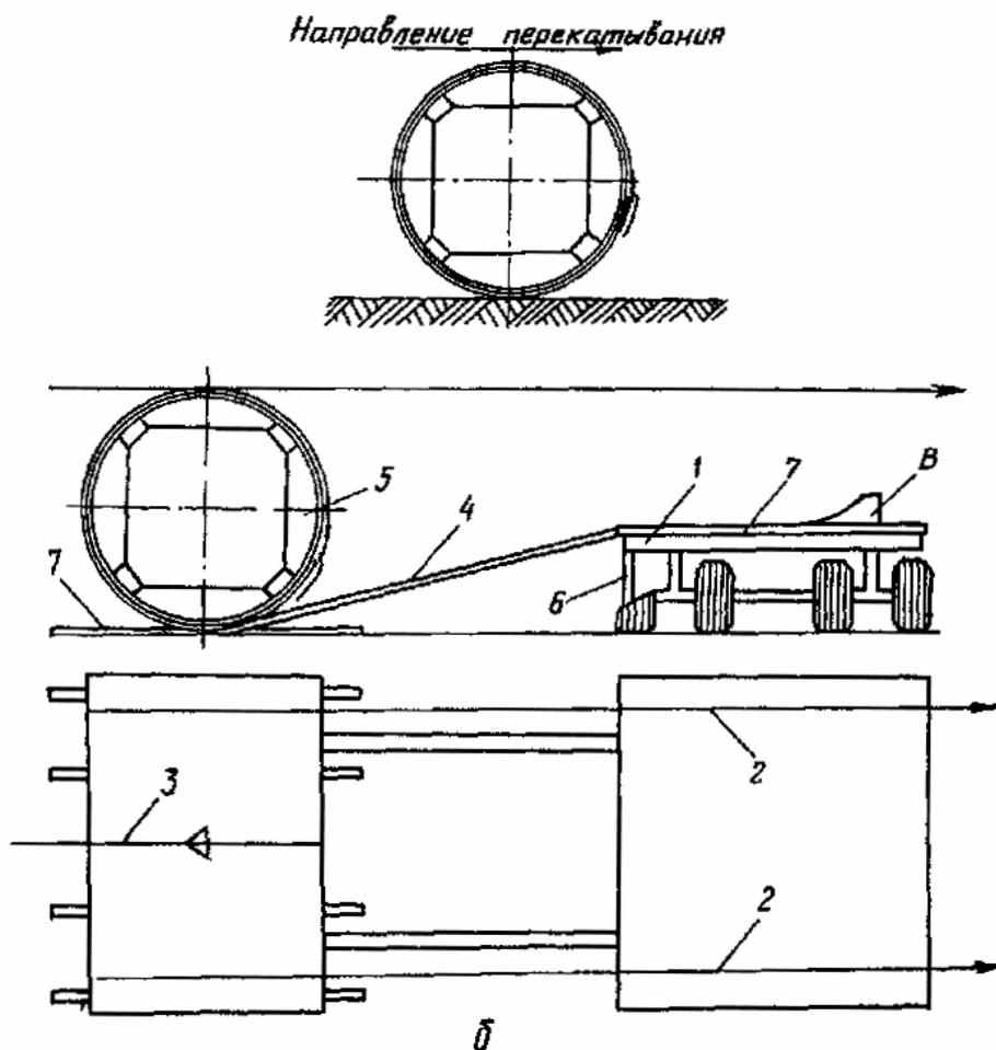
1 - прицеп (полуприцеп); 2 - тяговые канаты на лебедки или трактора; 3 - удерживающий (тормозной) канат; 4 - погрузочные балки; 5 - рулон; 6 - опорные стойки; 7 - подкладки из дерева; 8 - башмак
