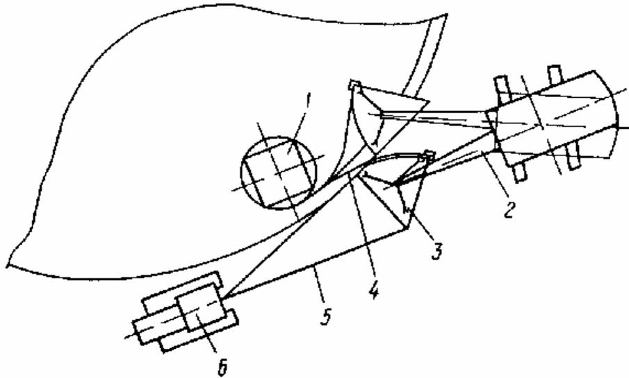
1 - рулон стенки; 2 - кран; 3 - гибочный сектор; 4 - формобразуемый участок полотнища;
