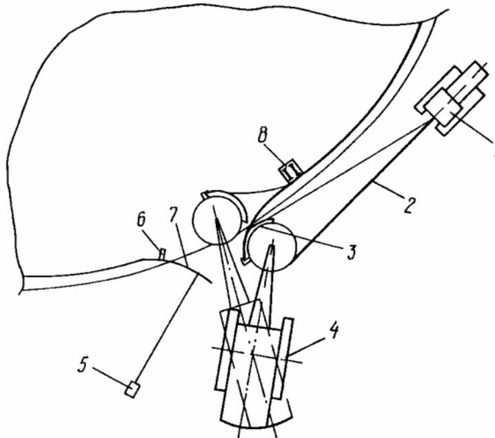
1 - трактор; 2 - тяговый канат; 3 - приспособление для формообразования; 4 - кран,
