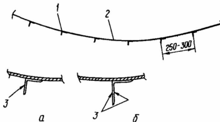
1 - ограничительный уголок; 2 - стенка резервуара; 3 - приварка
