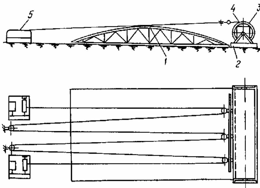
1 - стенд; 2 - опора; 3 - рулон; 4 - полотнище стенки; 5 - электрические лебедки
