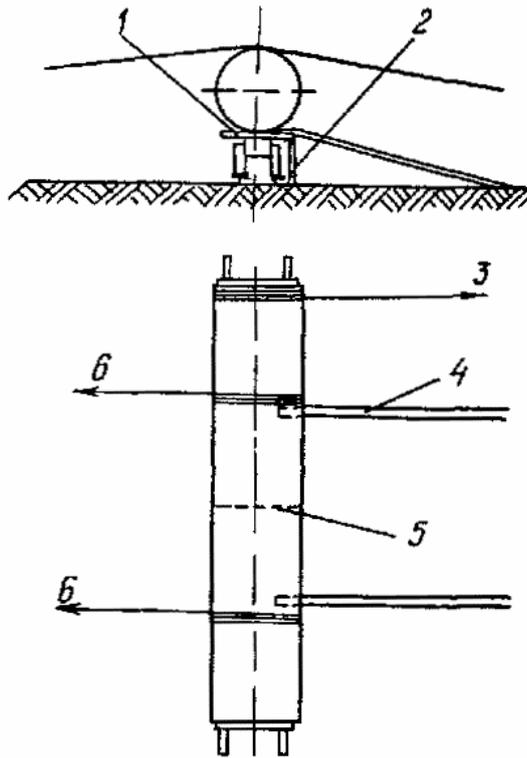
1 - железнодорожная платформа; 2 - опорные стойки; 3 - тяговый канат на лебедку или на трактор; 4 - разгрузочные балки; 5 - рулон; 6 - удерживающие канаты
