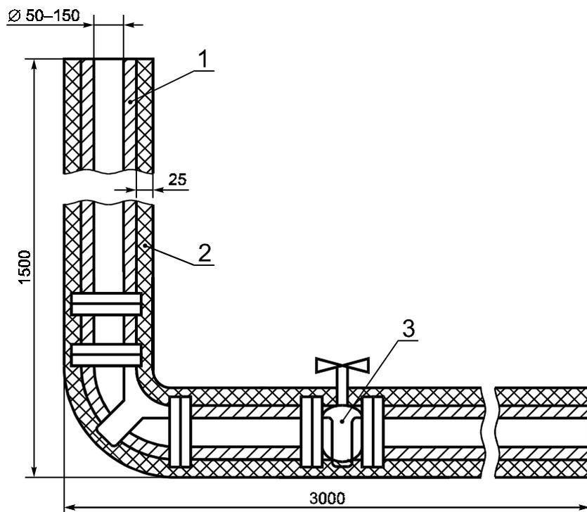
1 — стальная труба; 2 — теплоизоляция из стекловолна плотностью примерно 3,25 кг/м<sup>3</sup>; 3 — задвижка
