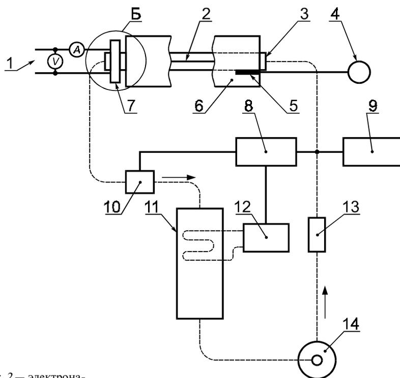
1 — источник регулируемого напряжения; 2 — электронагреватель; 3 — стальная труба внешним диаметром не менее 50 мм; 4 — температурный индикатор; 5 — термометр; 6 — изоляция из стекловолокна минимальной толщиной 25 мм и плотностью примерно  $3,25 \text{ кг/м}^3$ ; 7 — электрические выводы; 8 — контроллер температуры; 9 — датчик температуры; 10 — нагреватель; 11 — теплообменник; 12 — охладитель; 13 — расходомер; 14 — насос
