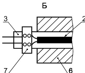
Рисунок 5 — Схема проверки номинальной выходной мощности
