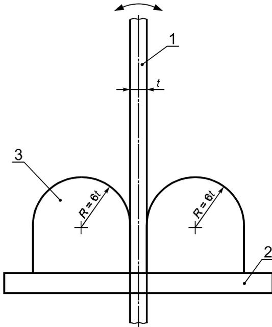
1 — образец кабеля; 2 — стальная плита; 3 — стальная оправа
