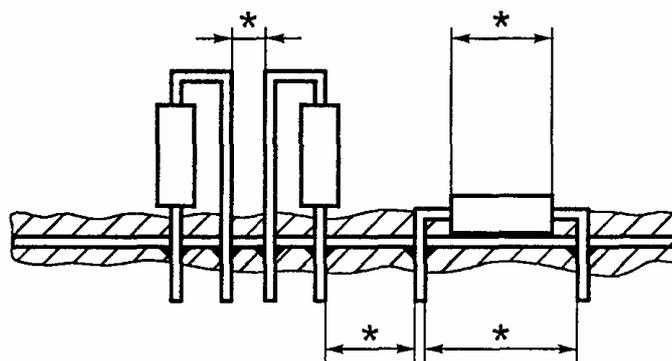
Выводы резистора не герметизированы в пределах покрытия, поэтому для всех размеров, отмеченных знаком \*, применимы требования 6.4.3 и 6.4.7
