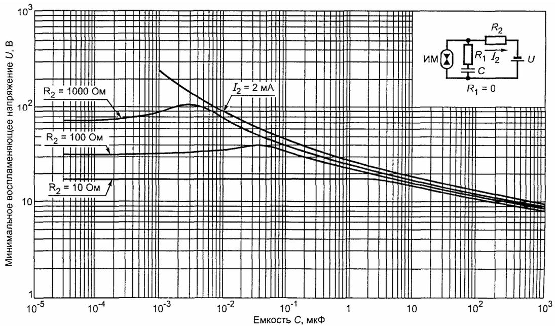
Рисунок А.12. Минимальное воспламеняющее напряжение в активизированной взрывоопасной водородно-кислородной смеси (81 %  $H_2$  + 19 %  $O_2$ ) для емкостных цепей подгруппы НА при  $R_1 = 0 \text{ Ом}$
