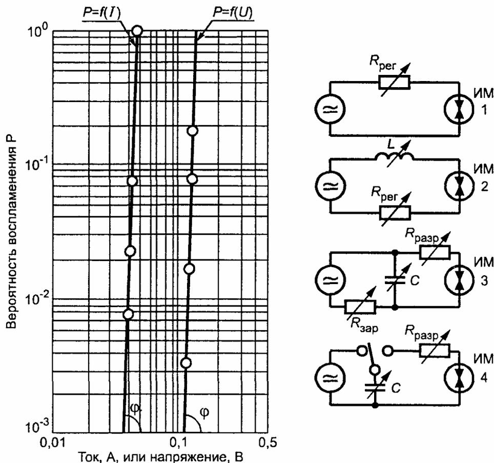
1 - омическая цепь; 2 - индуктивная цепь; 3 - емкостная цепь без отключения емкости; 4 - емкостная цепь с отключением емкости; R - резистор для регулировки тока в цепи; R - резистор для заряда емкости; R - разрядный резистор; ИМ - искрообразующий механизм; I - воспламеняющий ток; U - воспламеняющее напряжение
