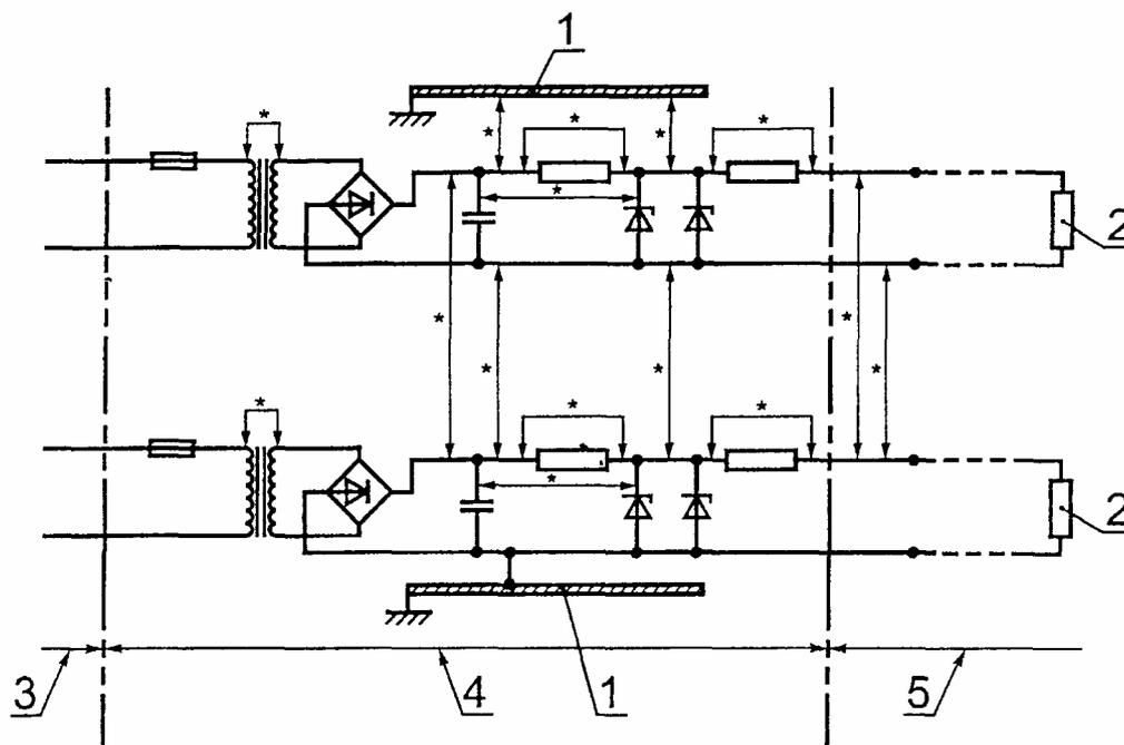
1 - шасси; 2 - нагрузка; 3 - искроопасная цепь, заданная  $U_m$ ; 4 - часть искробезопасной цепи, не являющаяся искробезопасной; 5 - искробезопасная цепь;
