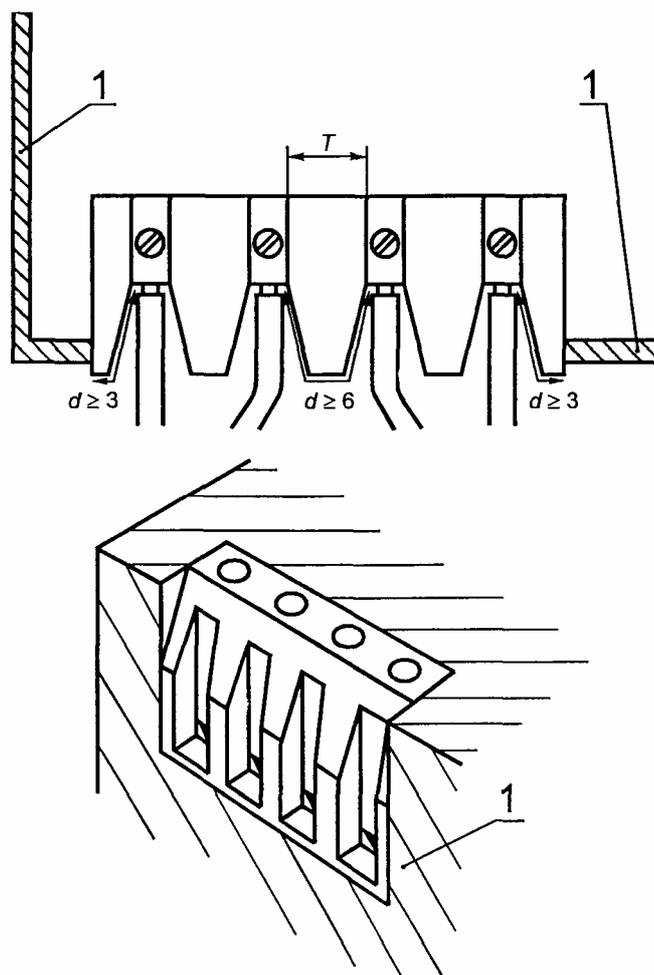
*I* - токопроводящий слой; *T* - зазоры и длина пути утечки в соответствии с таблицей 4;
