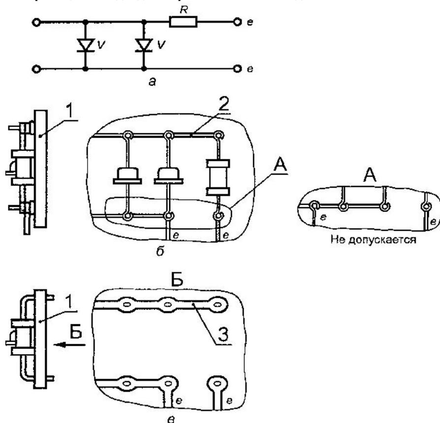
*a* - электрическая схема; *б* - навесной монтаж; *в* - печатный монтаж; *Y* - шунтирующий диод;
