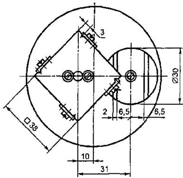
Рисунок Б.1. Кинематическая схема искрообразующего механизма I типа
