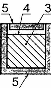
1 - свободная поверхность; 2 - герметизация; половина значения из пункта 3 таблицы 4 при минимальном значении 1 мм; 3 - компонент, герметизирующий материал не должен проникать; 4 - герметизирующий материал, толщина не задана; 5 - металлическая или изоляционная оболочка; для металлической оболочки толщину не указывают, (см. 6.4), для изоляционной оболочки толщина изоляции должна соответствовать значению пункта 4 таблицы 4
