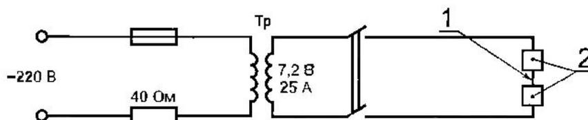
$T_p$  - трансформатор с площадью поперечного сечения сердечника  $19 \text{ см}^2$ ; 1 - вольфрамовая проволочка; 2 - медные бруски
