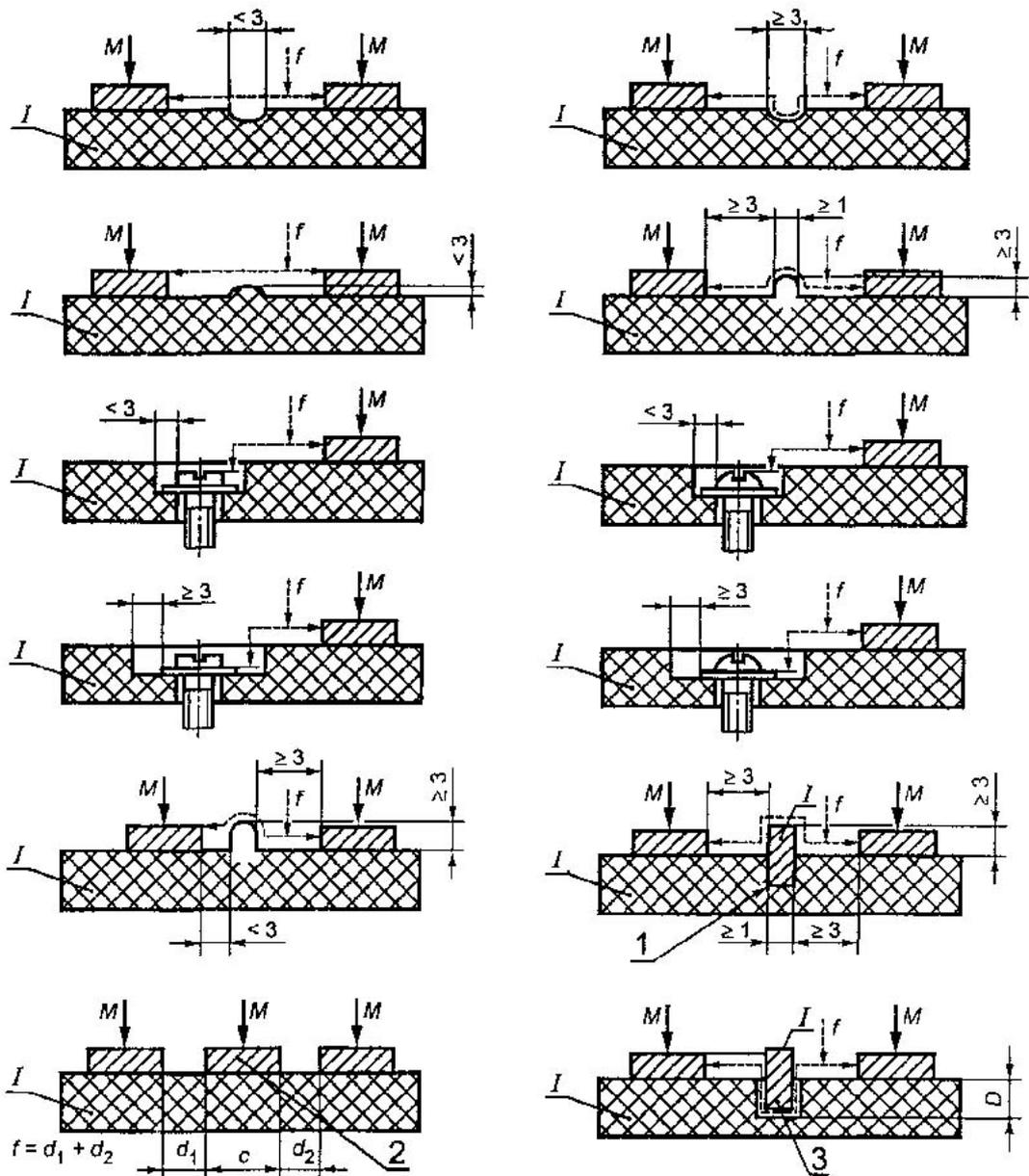
*f*- длина пути утечки; *M*- металл; *I*- изоляционный материал; 1 - приклеенная перегородка; 2 - центральная металлическая часть, не подключена к источнику напряжения; 3 - не приклеенная перегородка; высота разделительного углубления больше *D*
