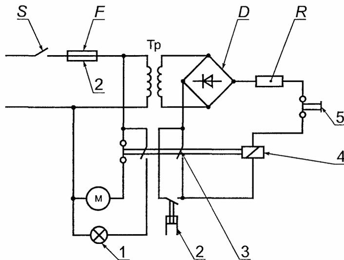
*S* - выключатель; *F* - предохранитель; *T<sub>p</sub>* - трансформатор; *D* - диодный выпрямительный мост; *R* - резистор; *M* - приводной двигатель; *1* - сигнальная лампа; *2* - датчик давления; *3* - удерживающий контакт; *4* - реле; *5* - кнопка сброса
