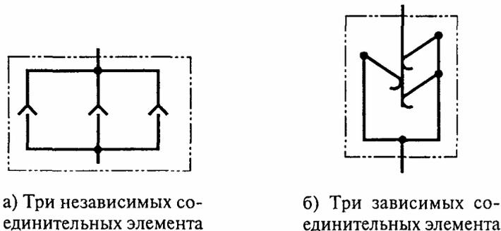
Рисунок 2. Примеры автономных и неавтономных соединительных элементов
