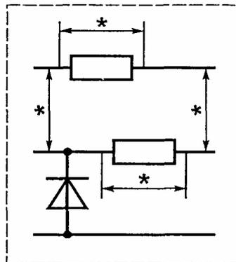
**г) Защита предохранителей в искробезопасной цепи**
