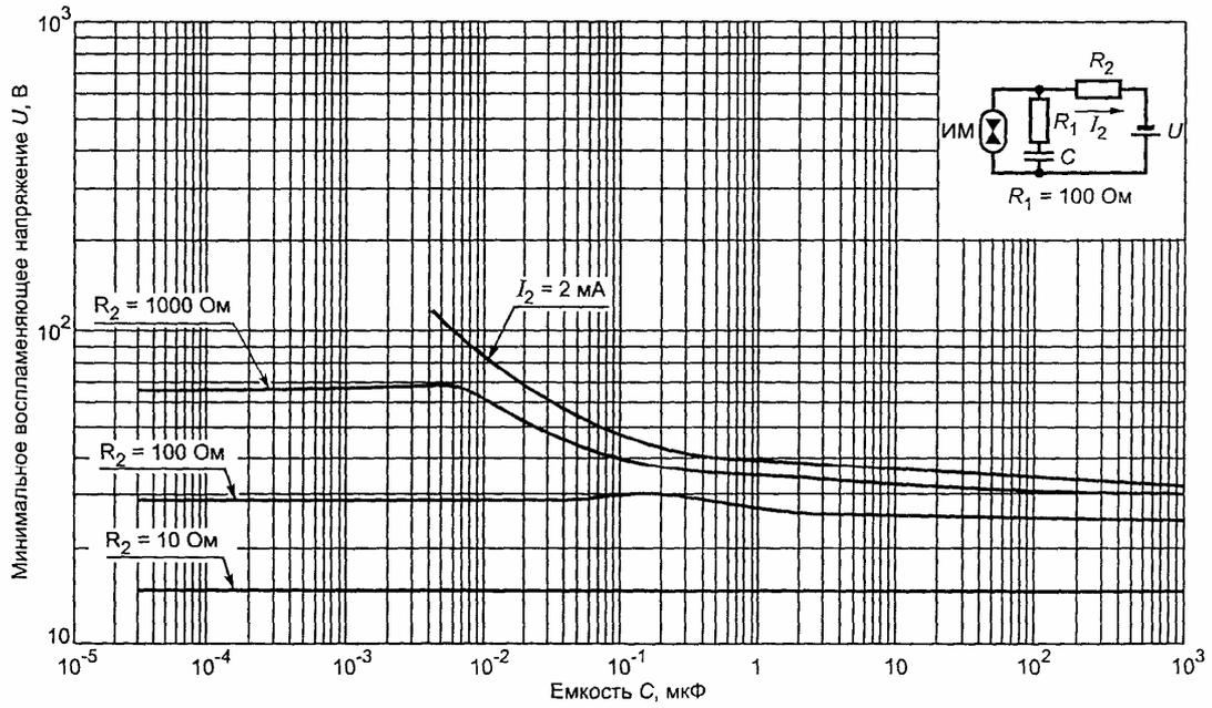
Рисунок А.18. Минимальное воспламеняющее напряжение в активизированной взрывоопасной водородно-кислородной смеси (75 %  $H_2$  + 25 %  $O_2$ ) для емкостных цепей подгруппы ИВ при  $R_1 = 100 \text{ Ом}$
