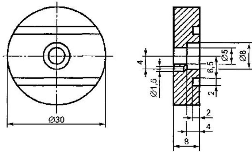
Рисунок Б.2. Кадмиевый контактный диск
