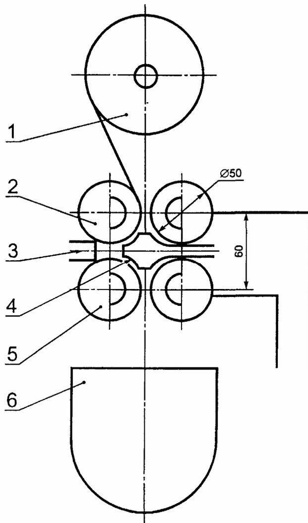
1 - барабан с проволокой; 2 - подающие ролики; 3 - датчик взрыва; 4 - взрывная камера;
