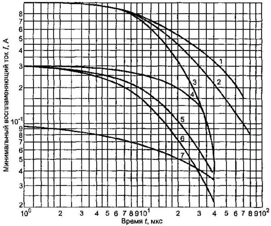
1-3 - индуктивность  $10^{-4}$  Гн, ЭДС источника 30, 45, 72 В соответственно; 4-6- индуктивность  $10^{-3}$  Гн, ЭДС источника 45, 72, 140 В соответственно, 7 - индуктивность  $10^{-2}$  Гн, ЭДС источника 72 В
